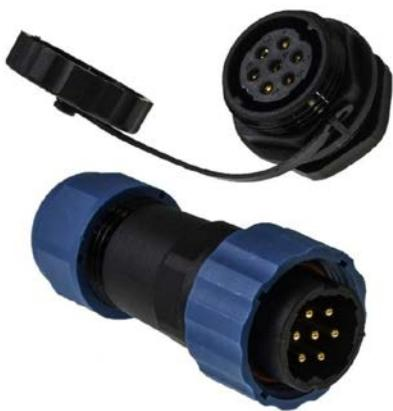
Герметичный разъем (комплект) с заглушкой SZC21 7P-M-FB, вилка-розетка, 7 контактов, диаметр входящего кабеля 12 мм, IP68, 10 А, 250 В, является пылезащищенным и влагозащищенным. Герметичный разъем соответствует высокой степени защиты, что гарантирует работу разъемов при длительном погружении в воду (более 30 минут) на глубину больше 1 м.
