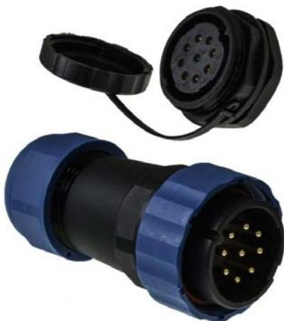
Герметичный разъем (комплект) с заглушкой SZC28 9P-M-FB, вилка-розетка, 9 контактов, диаметр входящего кабеля 15 мм, IP68, 10 А, 250 В, является пылезащищенным и влагозащищенным. Герметичный разъем соответствует высокой степени защиты, что гарантирует работу разъемов при длительном погружении в воду (более 30 минут) на глубину больше 1 м.
