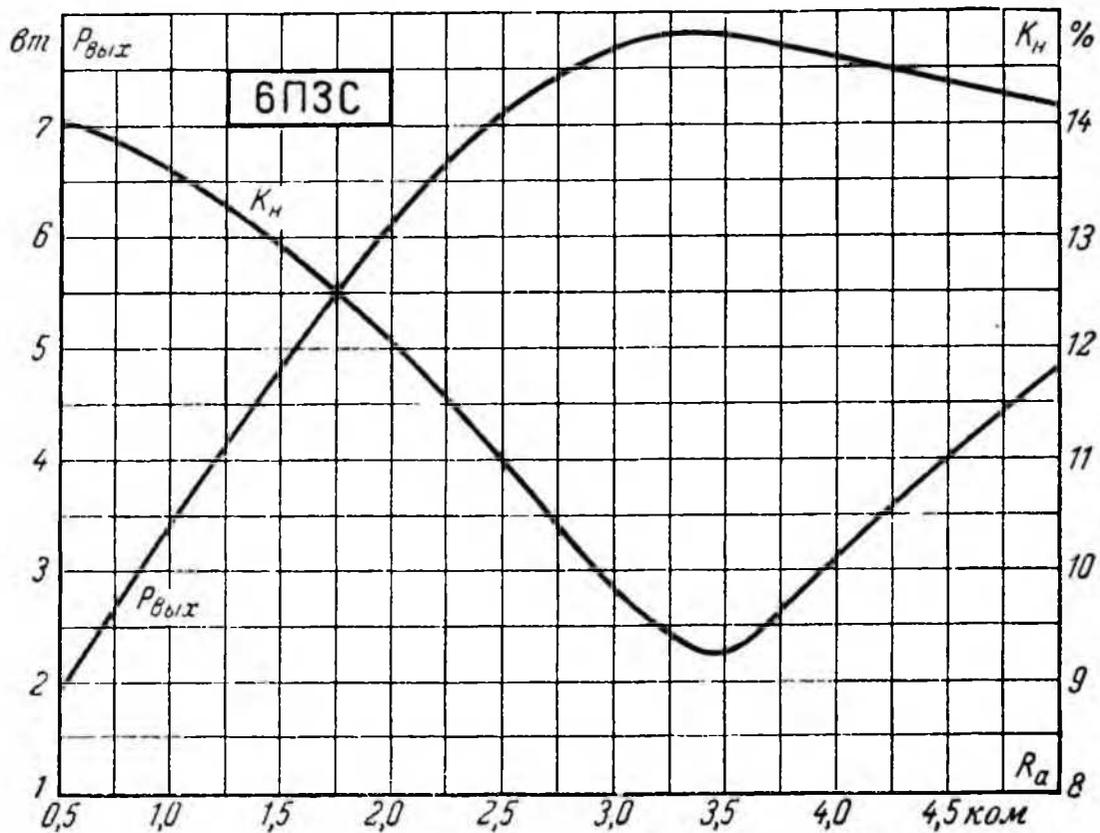
Динамические характеристики выходной мощности ( $P_{вых}$ ) и коэффициента нелинейных искажений ( $K_n$ ) лампы 6П3С в зависимости от сопротивления анодной нагрузки при напряжении анода 250 в, напряжении сетки второй 250 в, напряжении сетки первой минус 14 в и переменном напряжении сетки первой 9,8 в.
