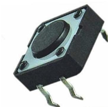
Тактовая кнопка RUiCHI KAN1211-0431B, 12x12x4.3 мм, OFF-(ON), 50 мА, 12 В, 100 мОм, толкатель с отверстием квадратный – это разновидность простейших механических выключателей, обеспечивающая замыкание контактов (без фиксации) только при наличии давления на поверхность штока (толкателя).
