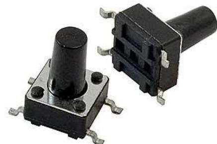
Тактовая кнопка RUICHI IT-1102WD, 6x6x9.5 мм, OFF-(ON), 50 мА, 12 В, 100 мОм – это разновидность простейших механических выключателей, обеспечивающая замыкание контактов (без фиксации) только при наличии давления на поверхность штока (толкателя).
